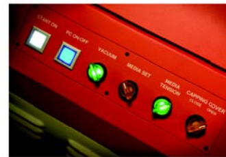
Hệ thống hút tự động của :Anapurna M1600 mang lại cân bằng áp suất trong suốt quá trình in ấn.
