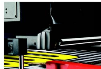
Bộ cảm ứng an toàn cụm đầu in ngăn ngừa việc va chạm với vật liệu in. Thanh ion hóa ngăn tĩnh điện. Cả 2 đều được lắp đặt trên cụm đầu in.
