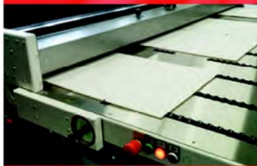
Hệ thống bàn nạp vật liệu phẳng, nạp nhiều tấm cùng lúc
